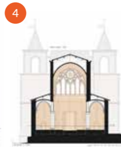
Fig. 4 Sezione AA', sezione trasversale all'interno della prima campata, in direzione dell'ingresso principale, quotato e in scala.
